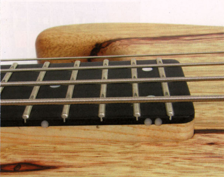
● Kunstharz-Griffbrett ist absichtlich dünn ausgeführt, um den Saitenklang nicht zu überdecken.
